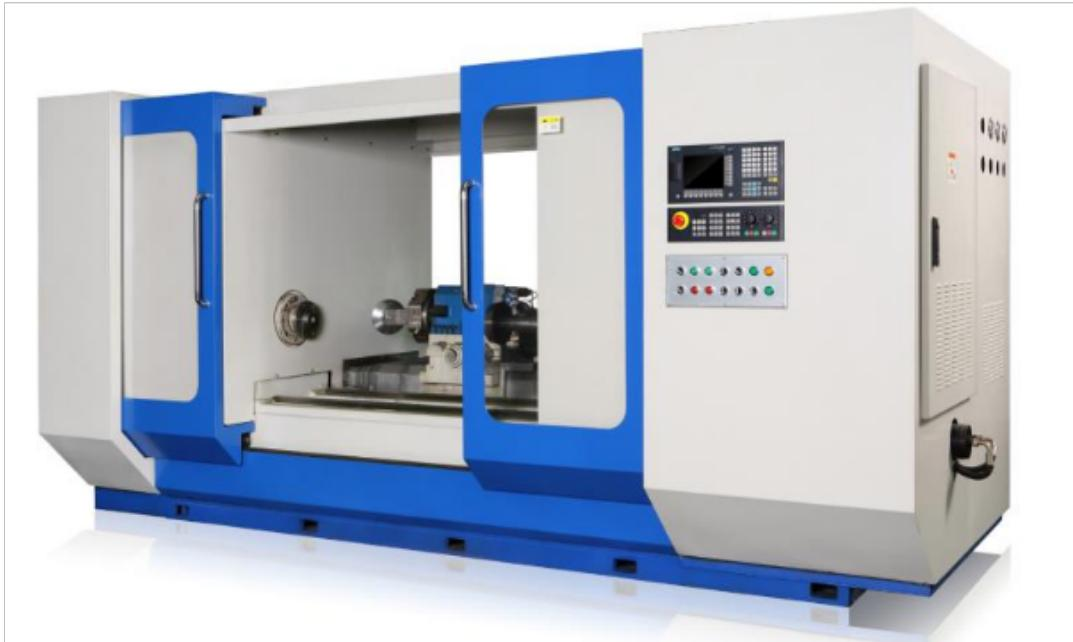
数控旋压机常见问题及解决办法（二）旋压机尾顶跳动对旋压成型产品有什么影响？旋压机尾顶跳动会对旋压成型产生一定的影响，主要有以下一些因素：1. 不锈钢因材料的延展率不好、受力大，当尾顶跳动时会因材料受力不均根部断裂。2. 铝材硬度小，旋压过程会因为尾顶跳动而刮花旋压产品底部。3. 尾顶跳动会造成料片和尾顶之间的接触面积不够，旋压受力会使料片产生移动。4. 尾顶跳动会影响产品成型后的尺寸精度，产品底部的直径精度变差。
