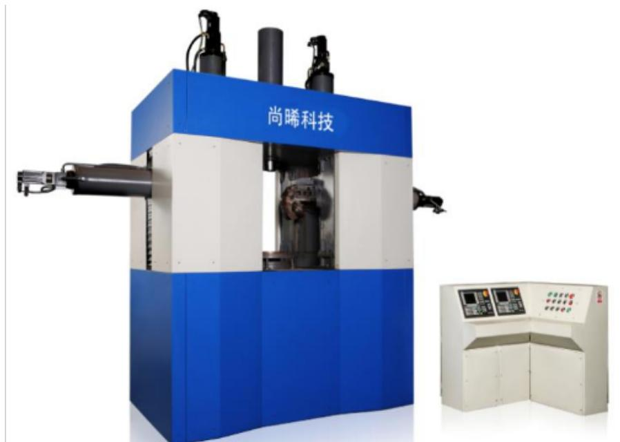
旋压成型和冲压拉伸成型的区别和优势（二）加工区别:对于一些简易的五金成型产品，拉伸冲压成型工序多，包括开料、成型、切边等基本工序，有些产品成型过程需经过多次拉伸，工序繁多但加工速度相对更快，而旋压成型和切削均可同时在一台数控旋压机床上完成，但单件加工速度会慢;对于一些拉伸高度长或异形的产品，拉伸冲压成型会导致产品开裂，但旋压更容易完成产品成型。产品区别:在产品的表面方面，旋压纹是呈圆圈式分布，拉伸痕是呈竖线分布;在产品成型后强度方面，旋压产品的强度会比拉伸冲压的强度会好很多。
